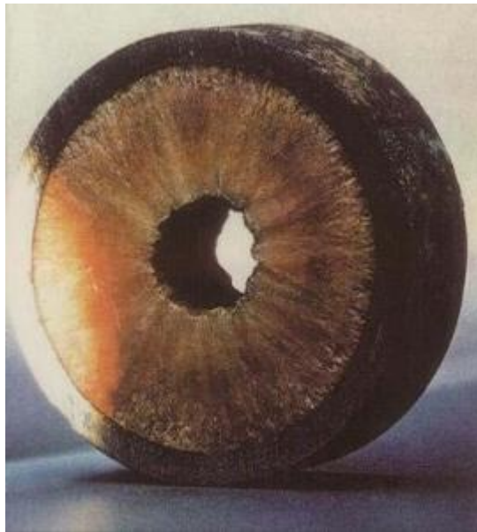
Figura 1 – Parafina depositada na parede interna de oleoduto Fonte: STATOIL (2011)
