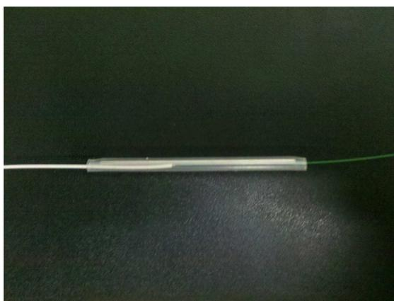
**Figura 39 – Emenda após a fusão**
