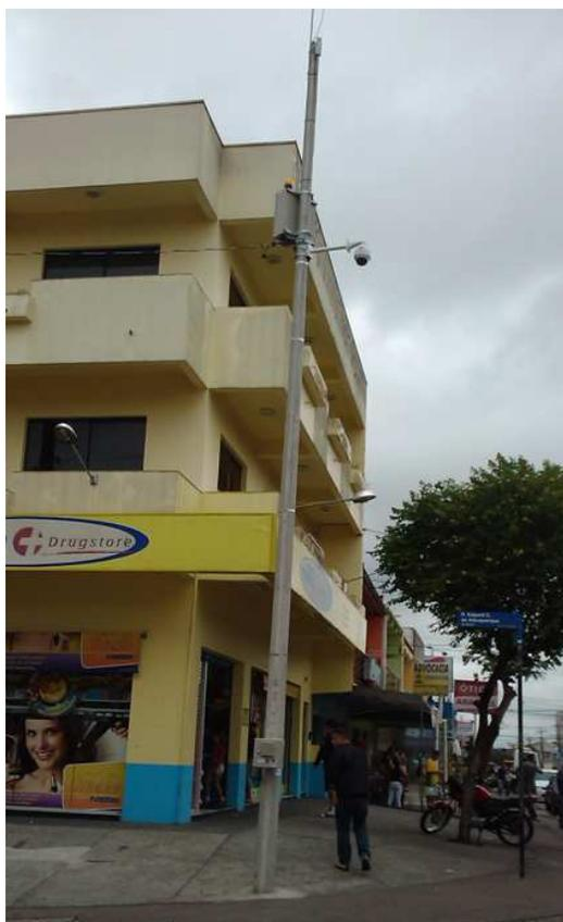
**Figura 48 – Ponto de videomonitoramento implantado**
