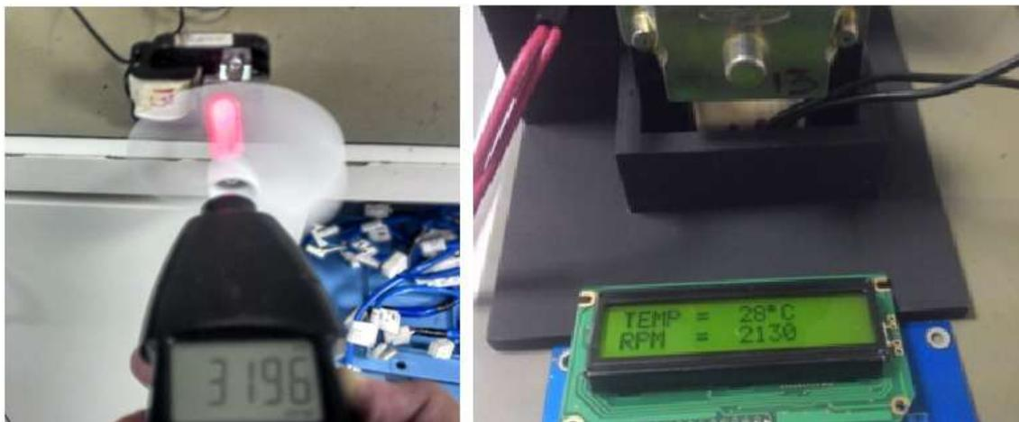
**Figura 34 – Ensaio do motor 13, com o tacômetro e com o sistema proposto**
