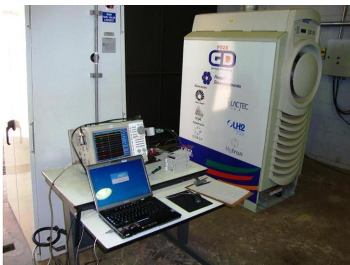
**Figura 16 - Configuração dos componentes do ensaio na MT Capstone C30**
