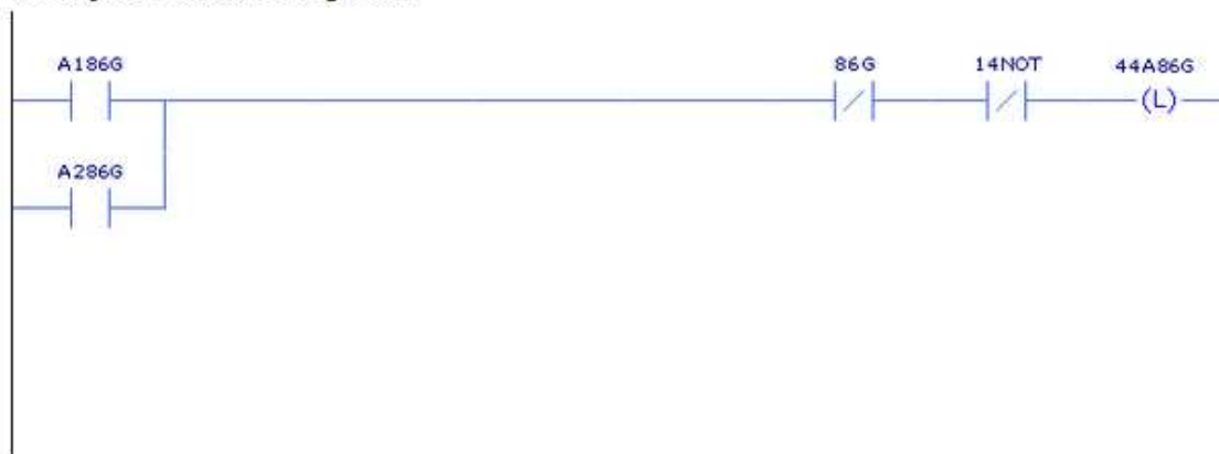
Figura 53 – Condições Parada de Emergência Fonte: Arquivo dos Autores.
