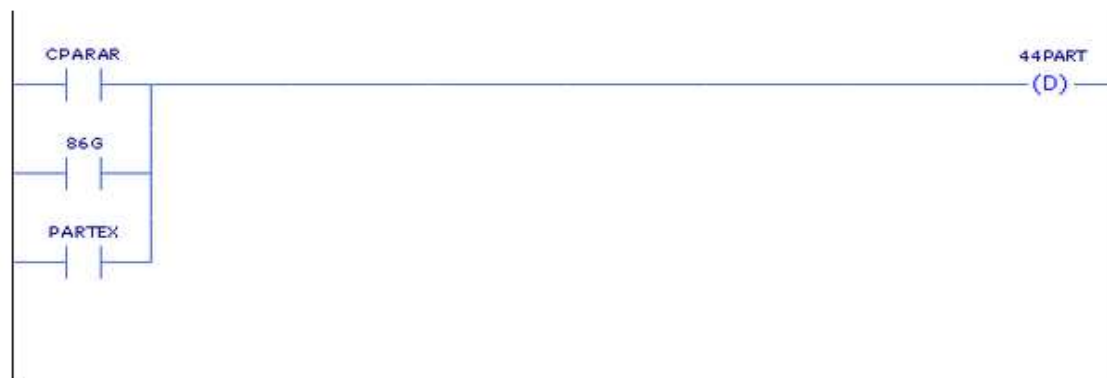
Figura 46 – Reset Relé Mestre Partida Automática Fonte: Arquivo dos Autores.
