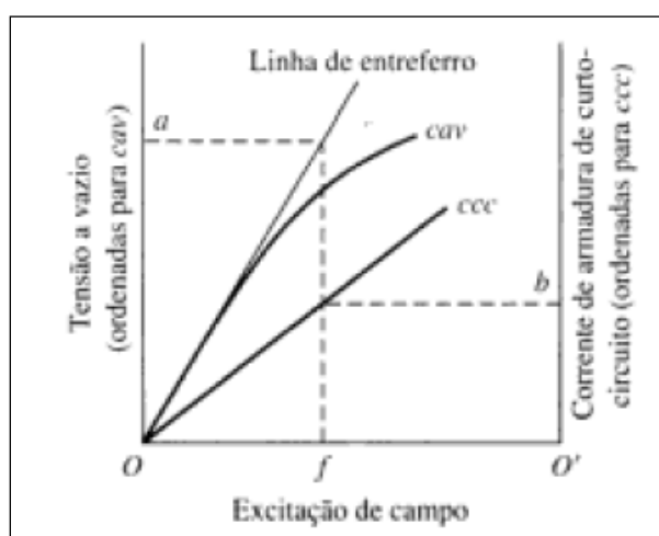
Figura 14 - Características a vazio e de curto circuito em uma máquina síncrona Fonte: CHAPMAN, 2013.
