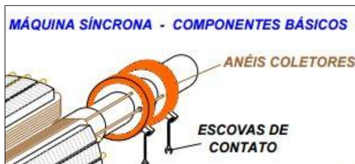
Figura 5 - Componentes das máquinas síncronas: Conjunto de escovas e anéis Fonte: MÁQUINAS SÍNCRONAS, 2014.
