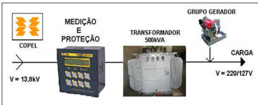
Figura 19 - Esquema do Grupo Gerador em Baixa Tensão Fonte: Autoria Própria.
