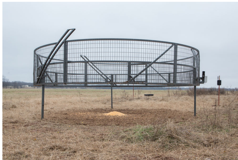
Figura 2: Armadilha BoarBuster acionada remotamente via internet.
