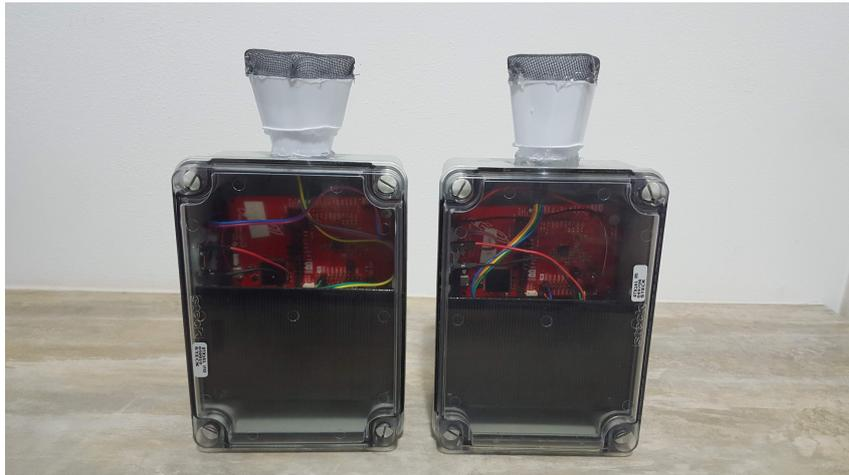
**Figura 20 – Montagem do abrigo do sensor no corpo do protótipo**
