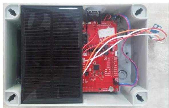
**Figura 19 – Construção - Painel fotovoltaico**
