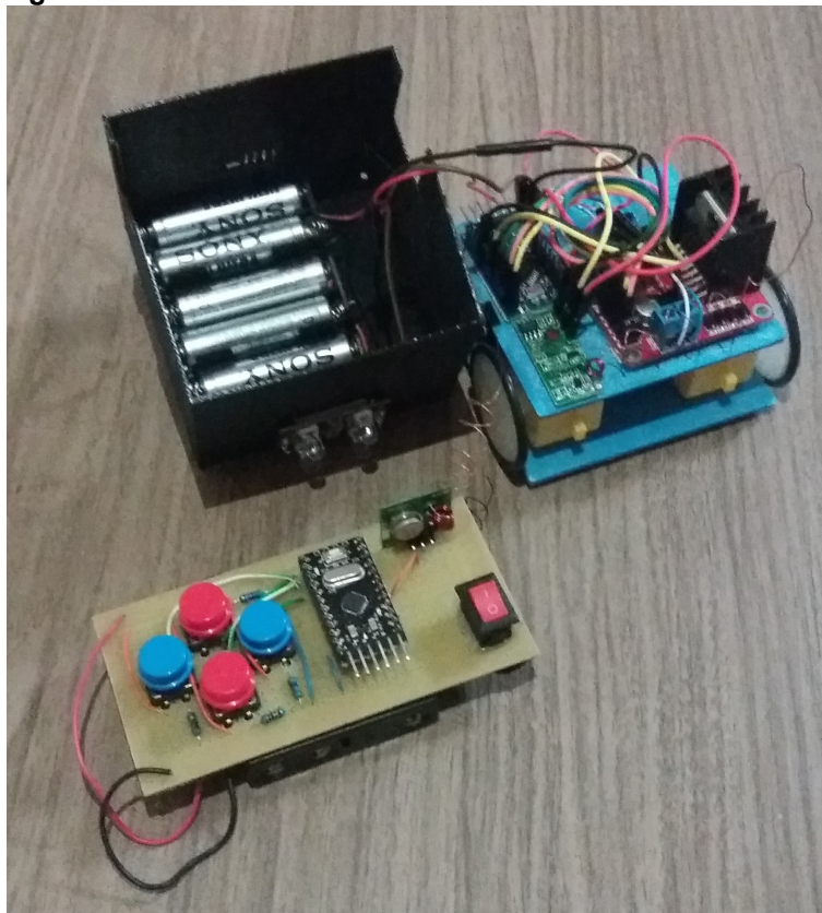
Figura 5 – Parte interna do Carrinho-Robô e controle remoto
