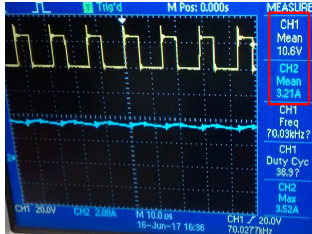
Figura 61: Ensaio de regeneração com o controlador atuando. Motor de carga operando em vazio. No canal 1, em amarelo, apresenta-se a tensão de saída em cima da chave Q_2 do conversor, enquanto no canal 2, em azul, tem-se a corrente de saída no conversor
