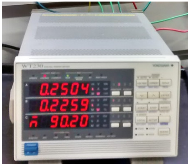
Figura 63: Analisador de potência Yokogawa WT230 Fonte: Autoria própria
