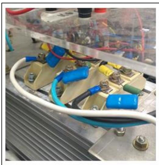
Figura 22 – Ligação das fases do motor com o banco de tiristores
