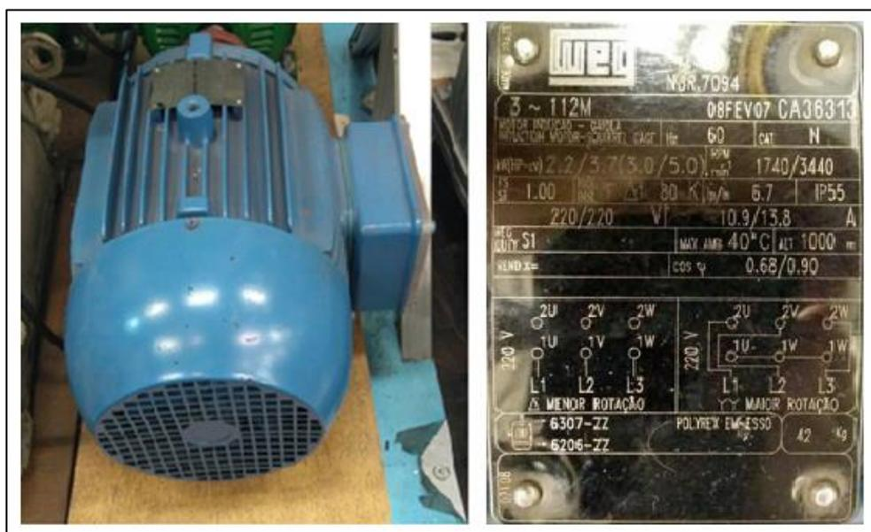
Figura 21 – Motor de indução do tipo gaiola de esquilo e suas características
