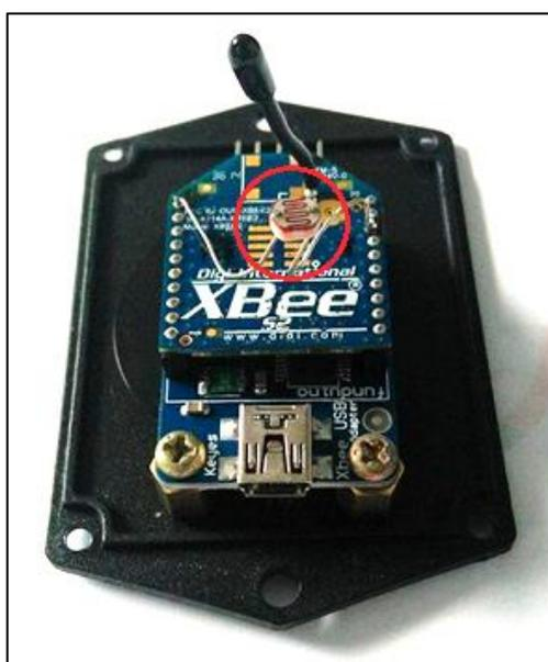
Figura 13 – Dispositivo de monitoramento de temperatura e luminosidade – visão superior
