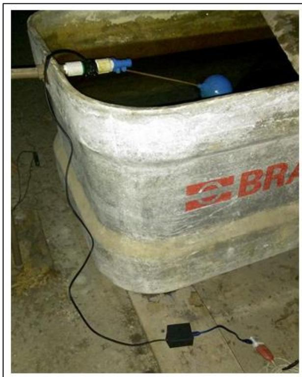
Figura 39 – Montagem do sistema de medição do consumo de água
