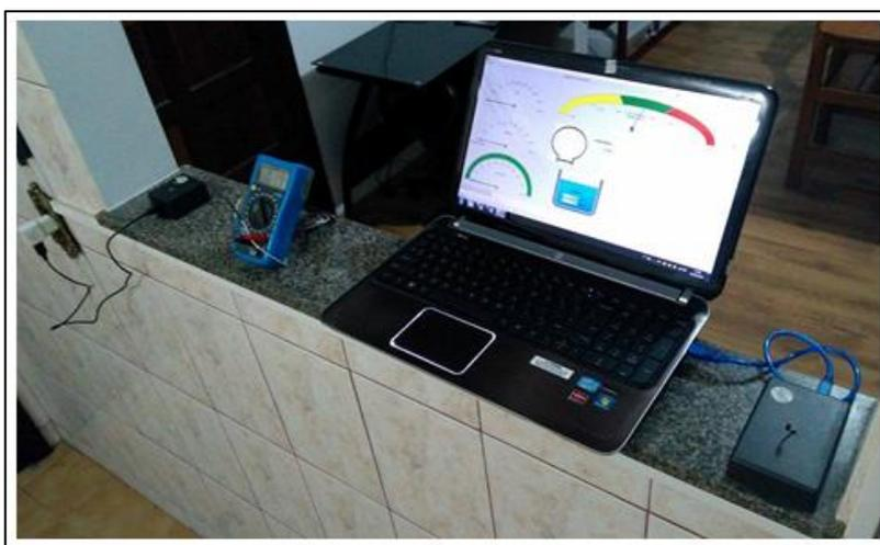
Figura 28 –Montagem do módulo de medição de temperatura
