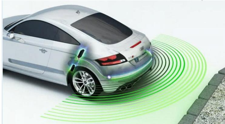
**Figura 16: Exemplo de aplicação de um sensor ultrassônico.**
