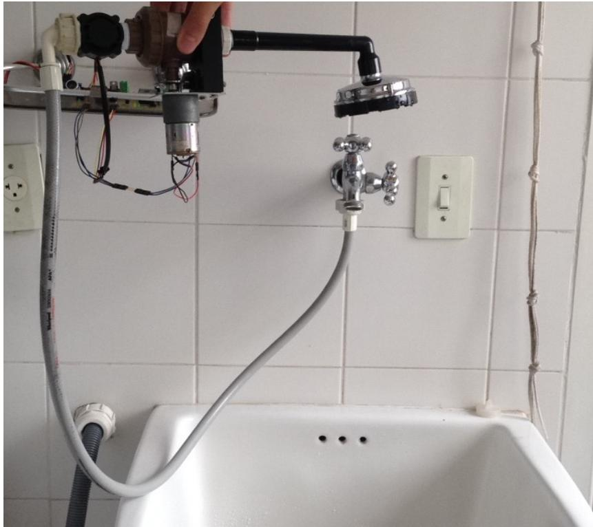
**Figura 39: Protótipo do chuveiro na fase de testes.**
