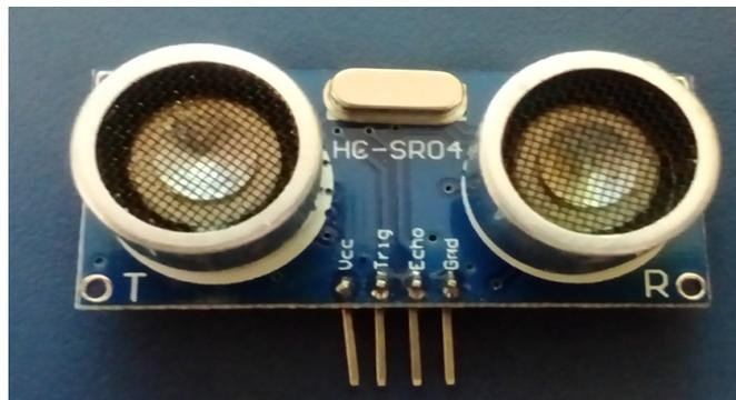
**Figura 28: Sensor ultrassônico HC-SR04.**
