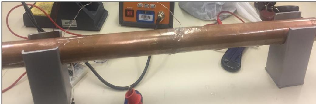
**Figura 29 - Tubo de cobre fabricado para utilização como prova do circuito de Howland Modificado.**
