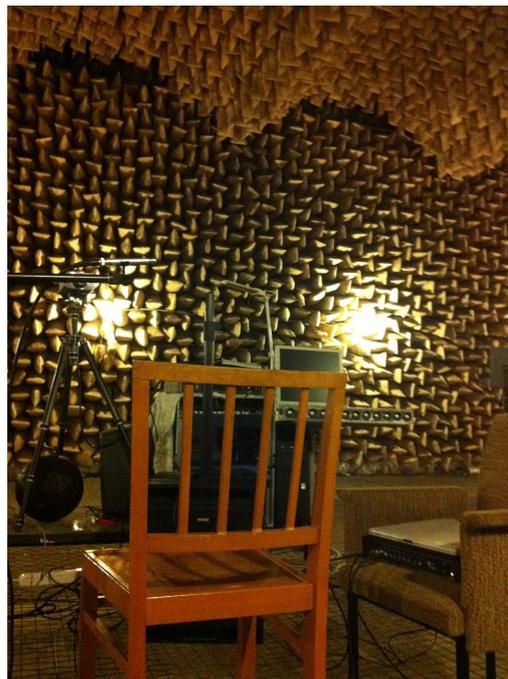
Figura 21 – Configuração da câmara anecoica para a realização dos ensaios
