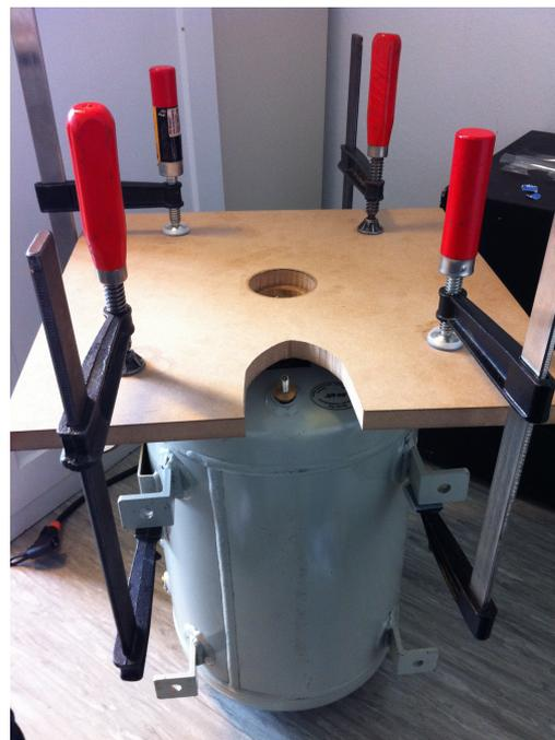
Figura 82 – Construção do protótipo de transdutor para geração de infrassom
