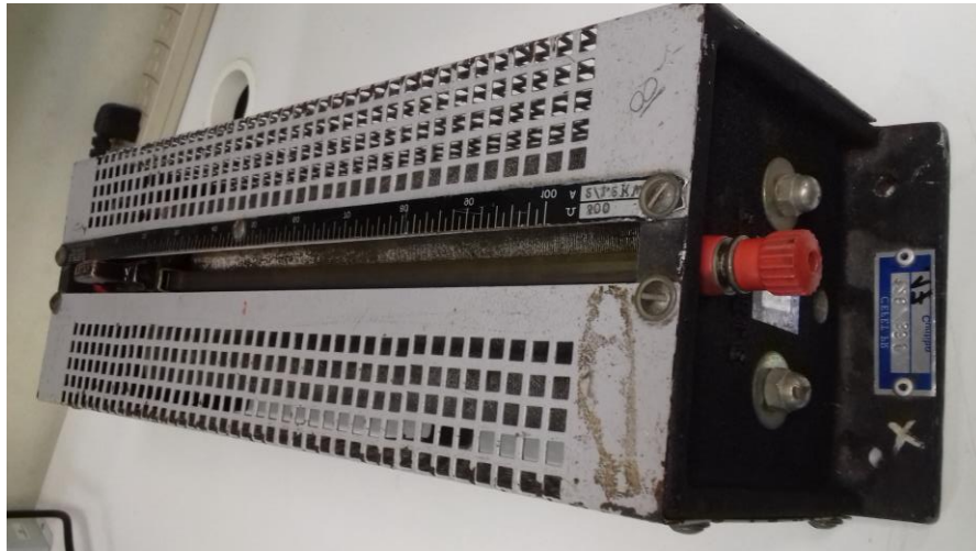
Figura 33: Reostato com deslocamento longitudinal de 300 \Omega /1200 W. Fonte: Autoria própria.
