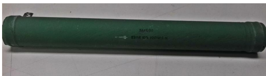
Figura 32: Resistor de fio fixo radial de 220 \Omega /100 W. Fonte: Autoria própria.
