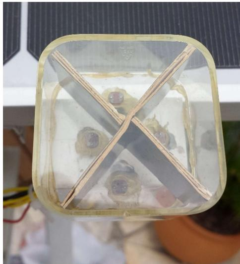
**Figura 24: Sensores de luminosidade**
