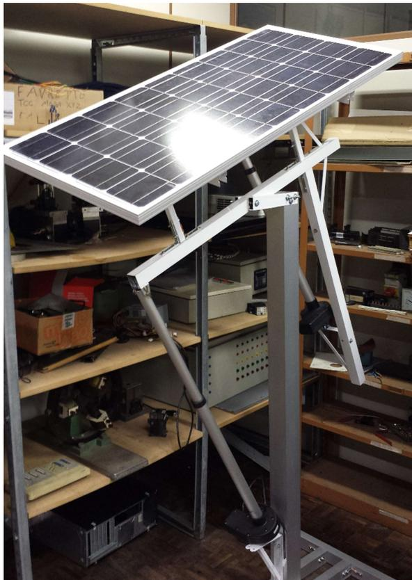
**Figura 21: Sistema Fotovoltaico Seguidor Solar com atuadores lineares**
