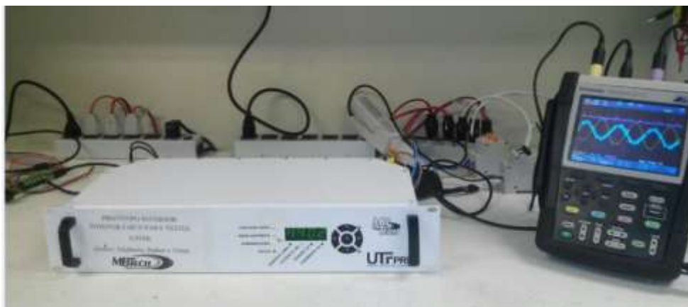
Figura 18 – Inversor avaliado sob ensaio em bancada Fonte: Autores.
