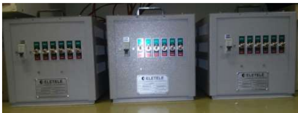
Figura 16 – Carga resistiva em paralelo com a fonte CA
