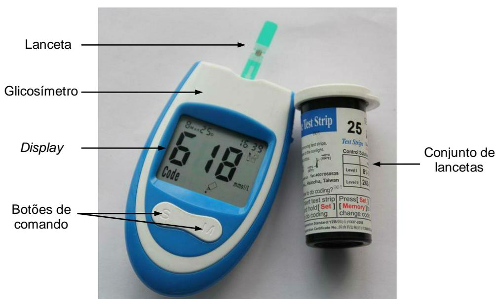
**Figura 1 – Exemplo de glicosímetro comercial para medição de taxa de açúcar no sangue.**
