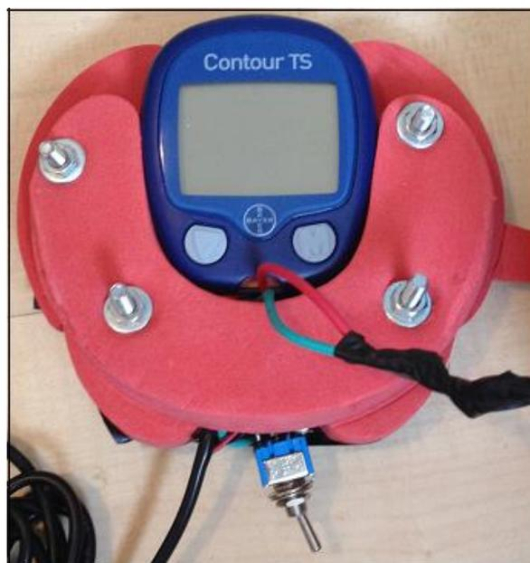
**Figura 12 – Visão superior do protótipo com glicosímetro posicionado.**
