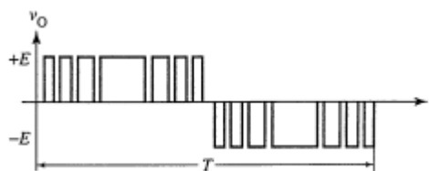
Figura 11 - PWM Senoidal AC básico. Fonte: Ahmed, 2000.
