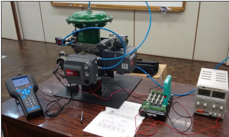
Figura 81 - Bancada de Comunicação FOUNDATION Fieldbus. Fonte: UTFPR, Campus Curitiba.
