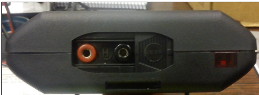
Figura 38 - Terminais HART e Fieldbus Fonte: UTFPR, Campus Curitiba.
