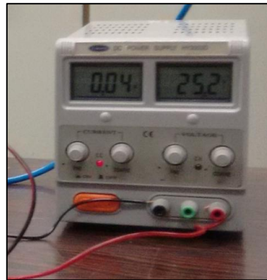
Figura 78 – Fonte de Tensão DC regulada para 24Vcc. Fonte: UTFPR, Campus Curitiba.
