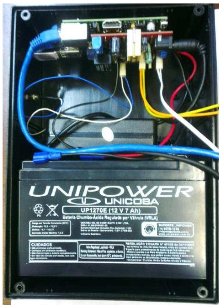
Figura 22 - Caixa com os Componentes
