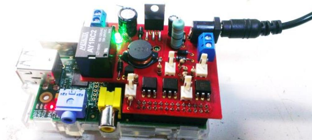
Figura 21 - Energização da Placa e Raspberry Pi
