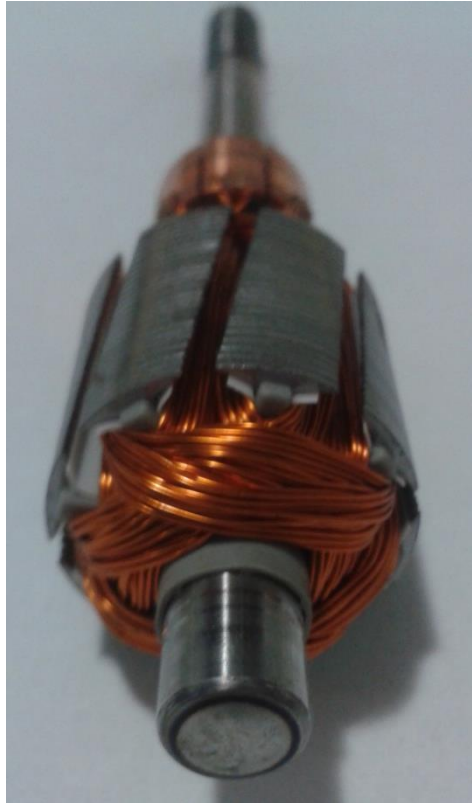
Figura 15 – Detalhe do enrolamento
