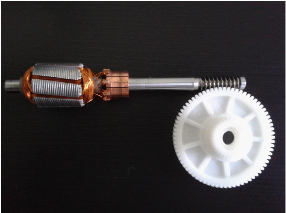
Figura 17 – Acoplamento entre engrenagem e rosca sem-fim
