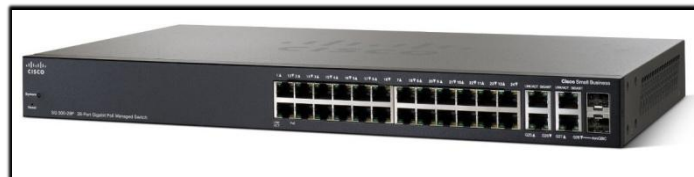
Figura 14 - Switch gerenciável 24 portas POE Fonte: Switch (2013).
