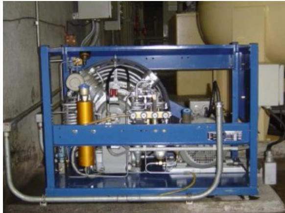
Figura 17 - Compressor de ar Fonte: Santiago, Becker e Kern (2004).
