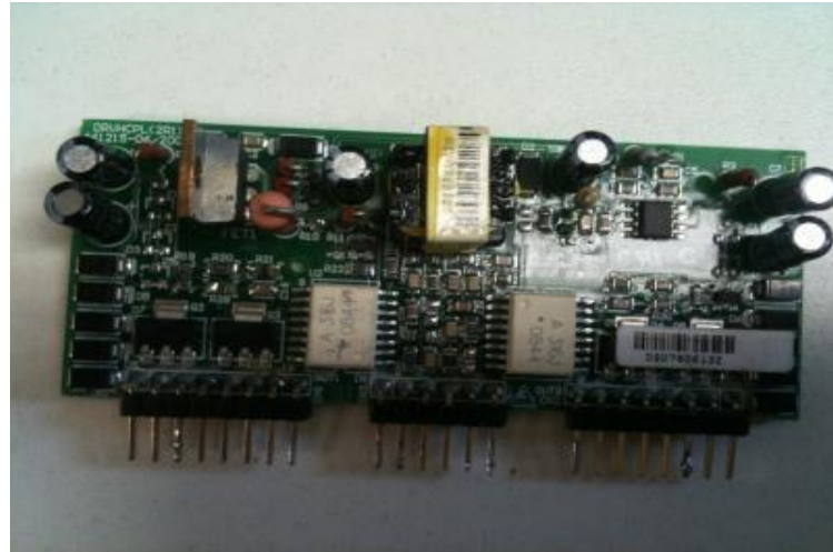
Figura 59 – Foto Placa do Driver DRVHCPL (2R1) Fonte: Própria
