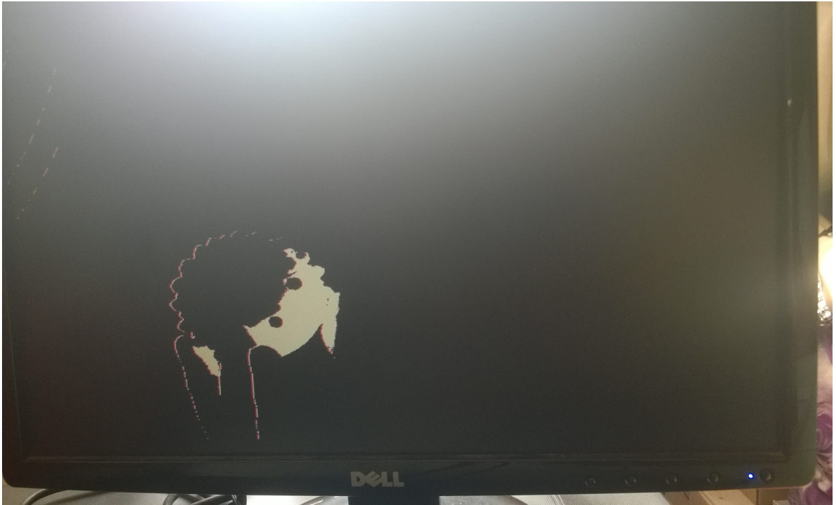
Figura 48: Imagem da bola rosada depois do processamento de imagem com limiar T = 85 . (Fonte: Própria)
