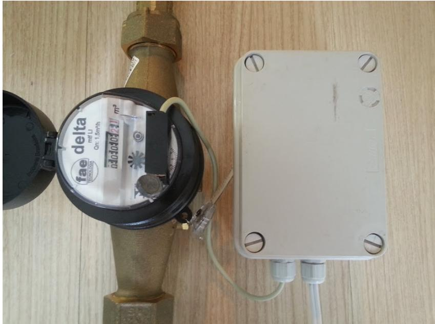
**Figura 4.5:** Foto do Sistema Embarcado Acoplado ao Hidrômetro fechado.
