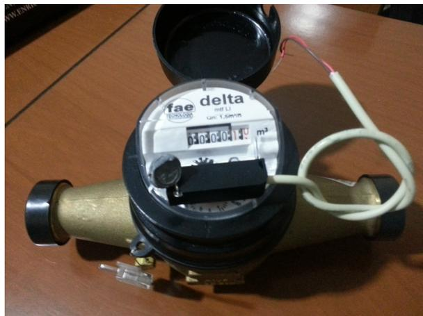
**Figura 2.1:** Exemplo de hidrômetro com saída pulsada.
