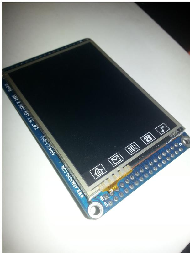
**Figura 2.3:** Exemplo de TFT Display.
