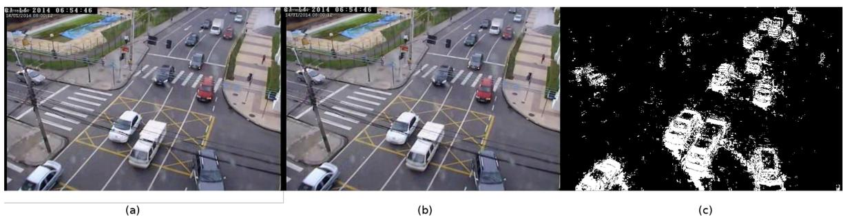
**Figura 11: Diferença em módulo entre as imagens seguidas de um limiar.**
