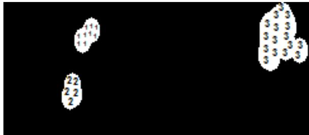
**Figura 22: Resultado após a aplicação da função labeling. Os números representam o valor de cada pixel.**
