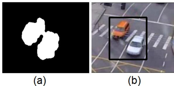
**Figura 15: Demonstração de situação onde dois veículos são representados em um único blob e o problema de segmentá-los como um único veículo.**
