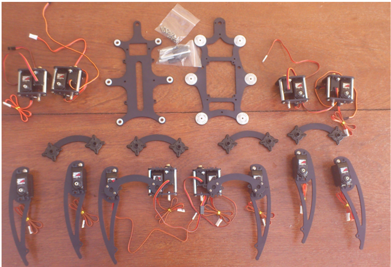
Figura 46: Peças do MSR-H01 com alguns servos encaixados
