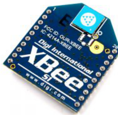
Figura 6: Módulo Xbee S1.
