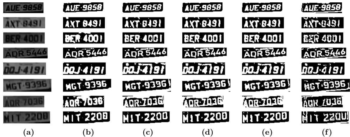
Figura 15: Exemplos dos resultados obtidos por cada método de segmentação: (a) imagem original em níveis de cinza; (b) Otsu; (c) Niblack; (d) Sauvola; (e) Wolf e (f) SnooperText .
