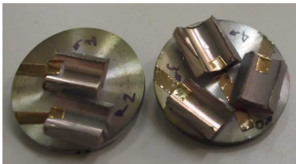
Figura 3.7 – Fotografia dos corpos poliméricos cortados e fixados aos suportes de alumínio, após recobrimento de ouro, para análise por MEV.
