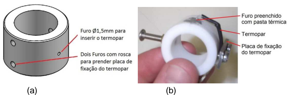
Figura 3.16 - Detalhes do corpo com adaptação do termopar para medição da temperatura no contato: (a) vista em perspectiva com detalhes acrescentados (b) fotografia da montagem do termopar no corpo.
