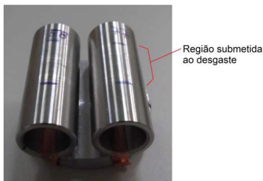
Figura 3.10 – fotografia dos contra-corpos de aço inoxidável para análise por MEV.
