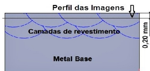
Figura 3.11: Representação esquemática do perfil das imagens da microestrutura. Fonte: Do autor.
