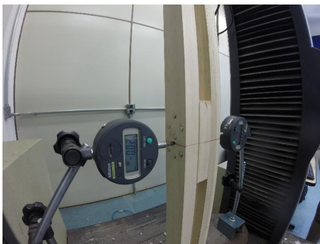
Figura 26: Detalhe dos transdutores de deslocamento posicionados a meia altura Fonte: Autor (2016)
