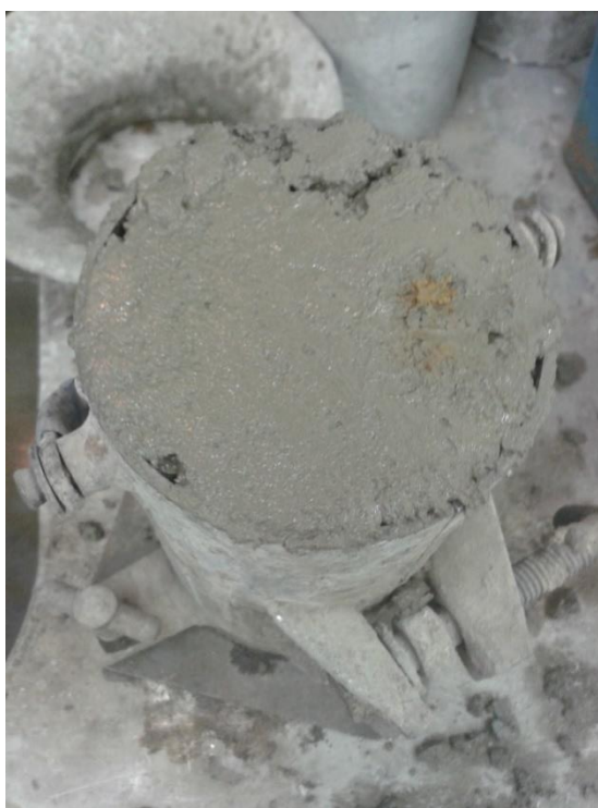
Figura 9- Presença de aglomerados de lodo na superfície do corpo-de-prova Fonte: Autoria Própria
