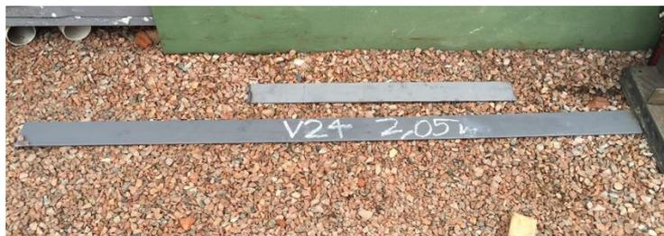
**Figura 10 - Superfícies decapada (acima) e superfície com pintura anticorrosiva (abaixo).
