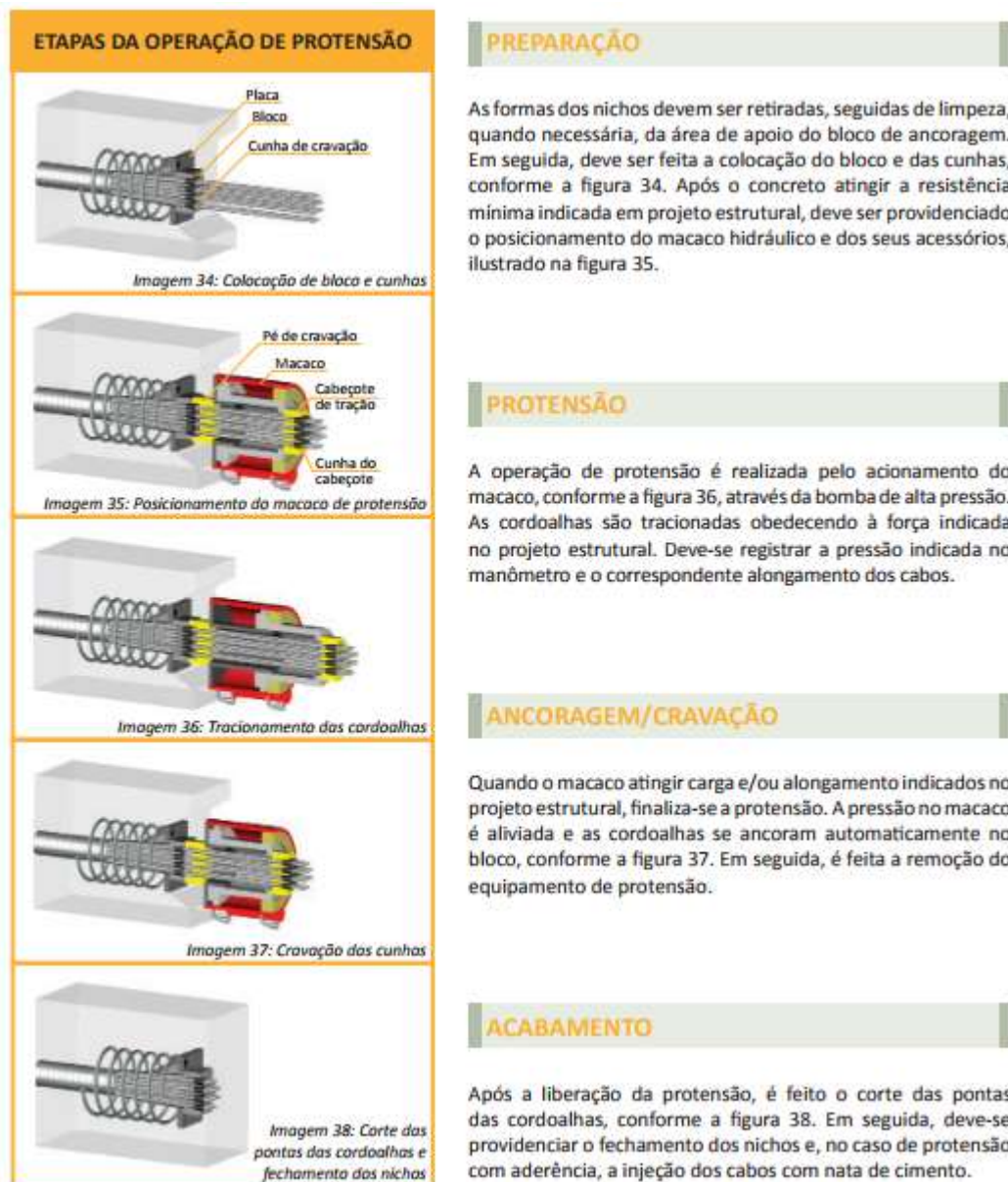
Figura 21 – Etapas do processo de protensão
