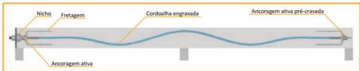
Figura 7 – Corte longitudinal esquemático de protensão não aderente
