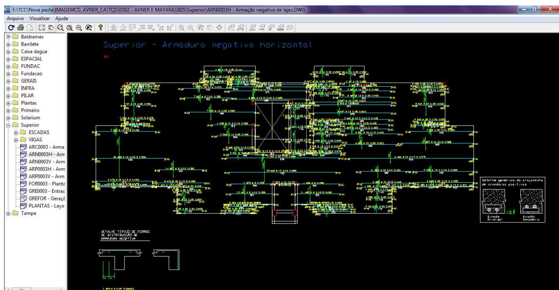
Figura 38 – Dimensionamento de armaduras negativas horizontais em LLMA
