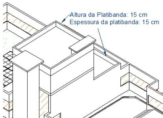
Figura A13– Detalhe das platibandas curtas e áreas de acúmulo de água
