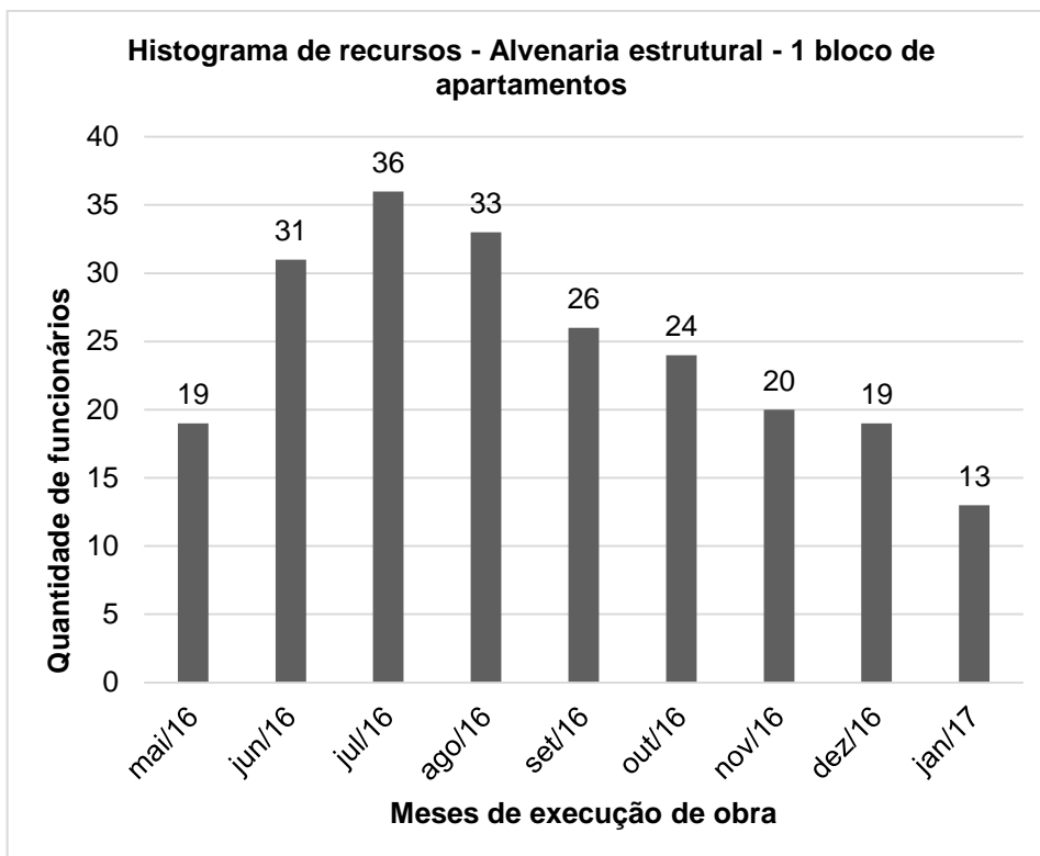
Figura 22 - Histograma de recursos para construção de 1 bloco de apartamentos em alvenaria estrutural Fonte: Autoria própria.
