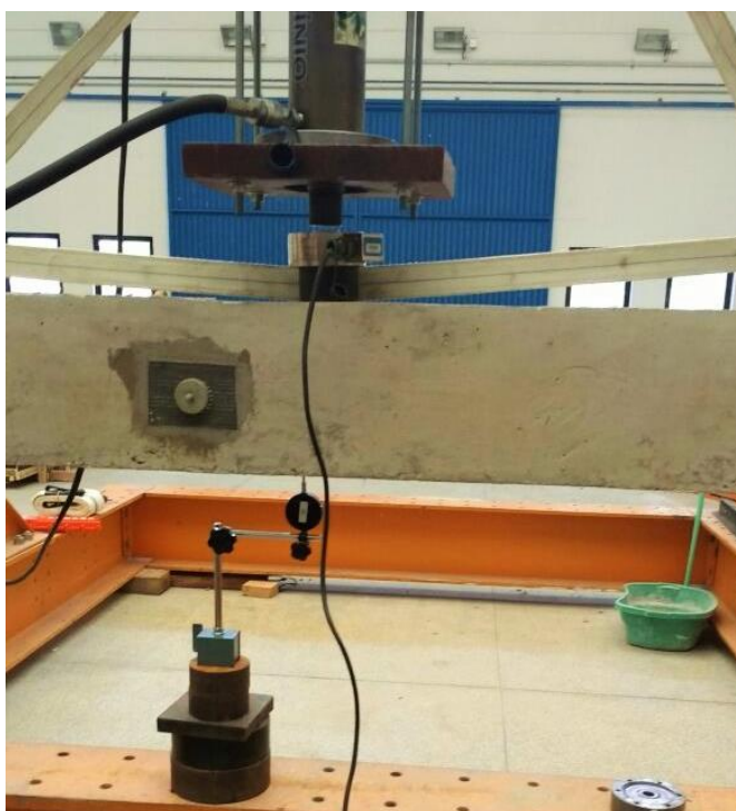
Figura 30 – Detalhe da disposição do relógio comparador e célula de carga Fonte: Autoria Própria.
