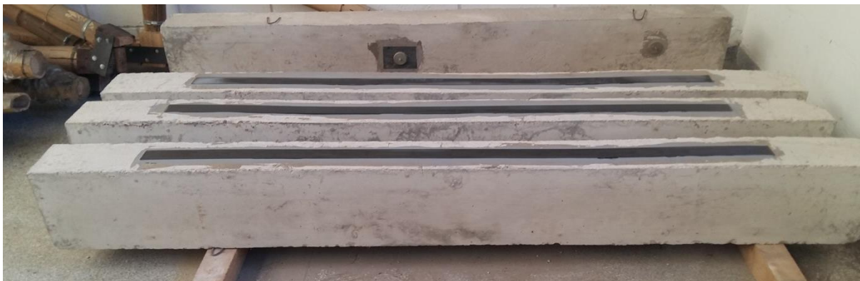
Figura 26 – Vigas do Grupo 2 após a execução do reforço Fonte: Autoria Própria.
