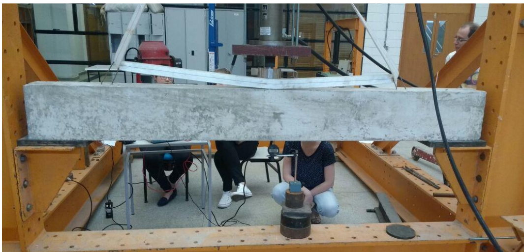
Figura 28 – Viga posicionada para início do rompimento Fonte: Autoria Própria.
