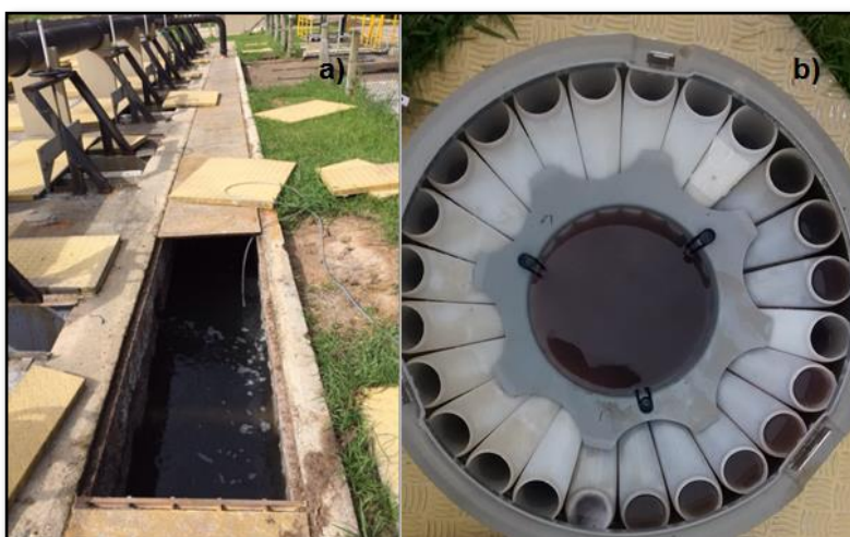
Figura 7 – Ponto de coleta das amostras: a) Ponto de coleta; b) amostras coletadas no amostrador.
