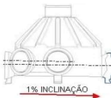
Figura 9 - Vista lateral de um tubo de inspeção e limpeza (TIL) Fonte: Adaptado de TIGRE, 2013.
