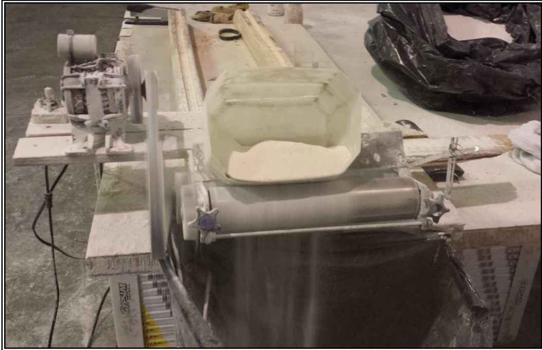
Figura 10 - Segundo tritramento eletro-mecânico para redução do tamanho das partículas.
