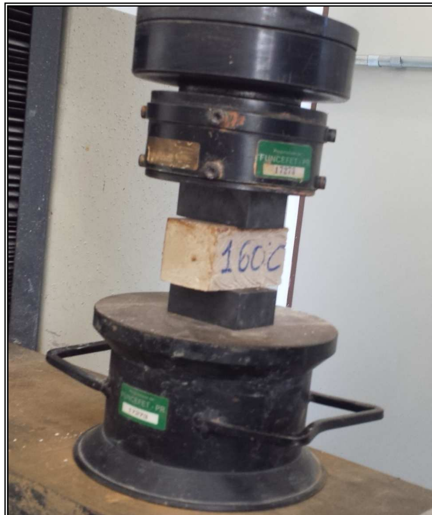
Figura 23 - Ensaio de compressão, corpo de prova 160 °C - 4 h sendo comprimido entre 2 placas metálicas.
