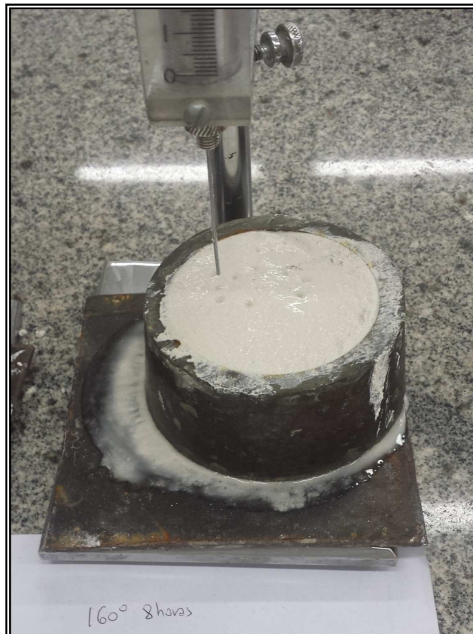
Figura 28 - Amostra de gesso calcinado a 160 °C por 8 h. Fonte: Autoria própria.
