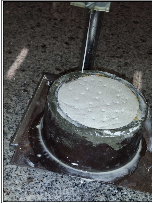
Figura 29 - Amostra de gesso calcinado a 200 °C por 8 . Fonte: Autoria própria.
