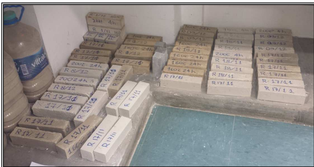
Figura 21 - Corpos de prova armazenados e identificados aguardando data para ensaio. Fonte: Autoria própria.
