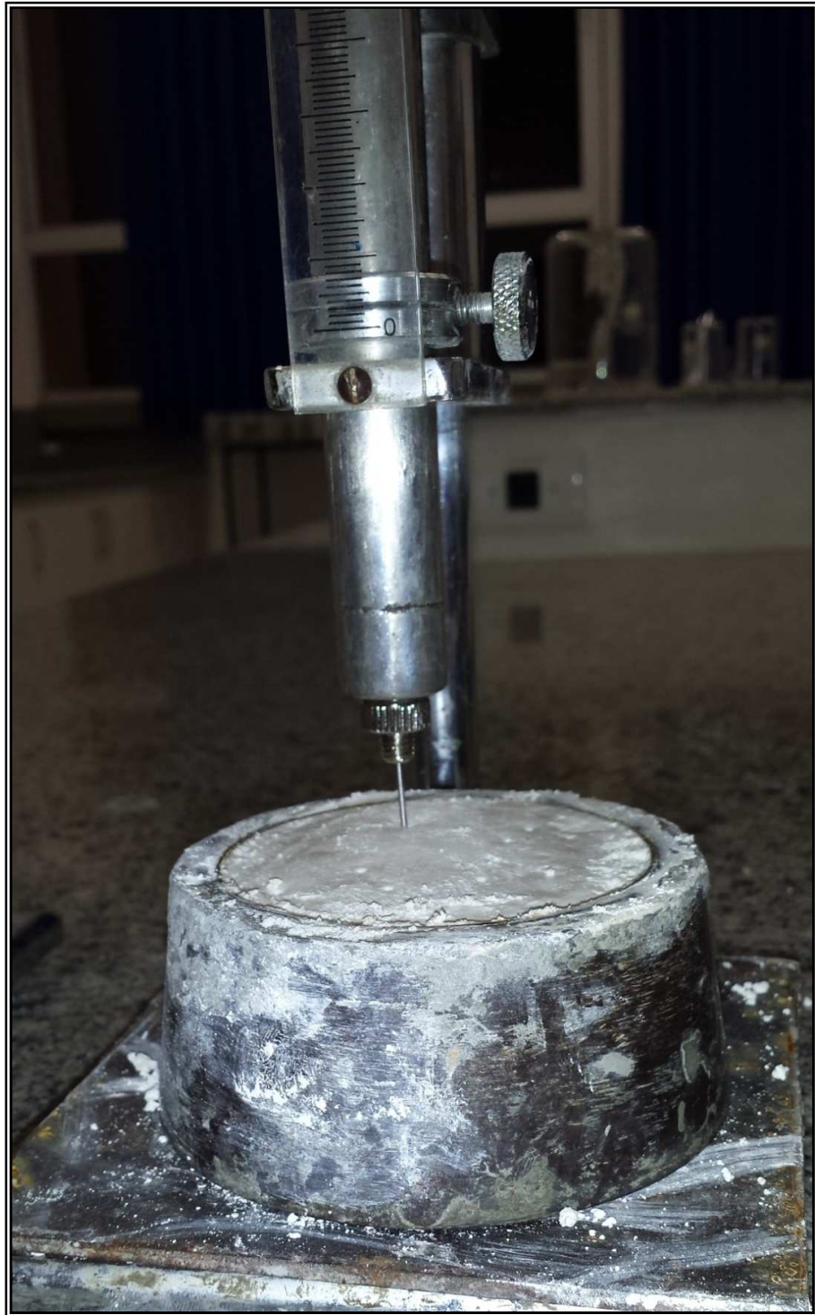
Figura 17 - Instantes após o início de pega, agulha estacionada a 3 mm da base. Fonte: Autoria própria.
