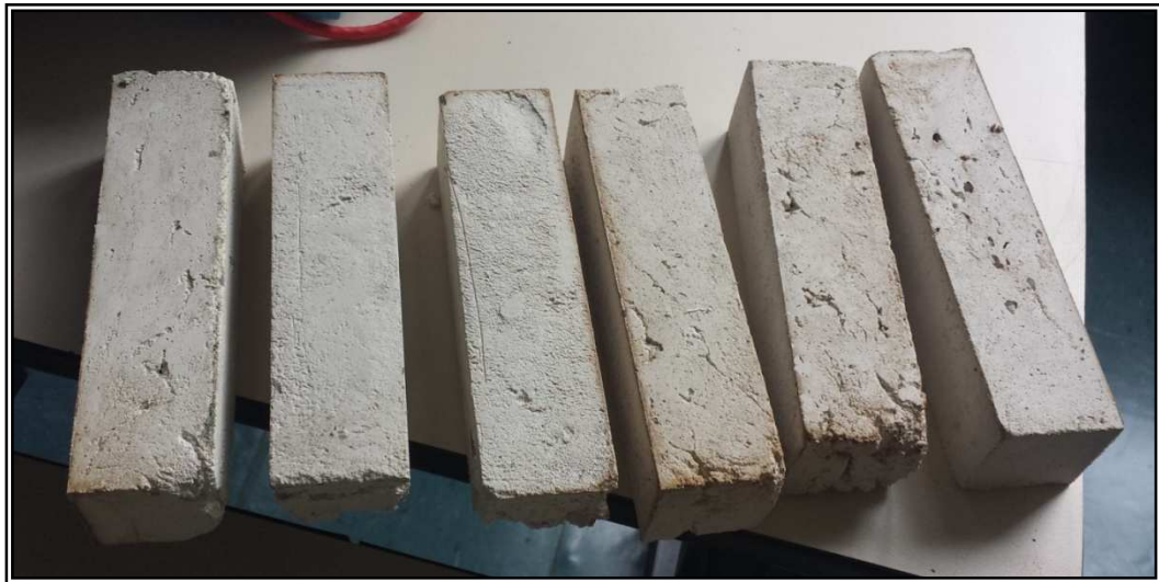
Figura 32 - Amostras de gesso calcinado a 180 °C por 4 h apresentando não homogeneidade.
