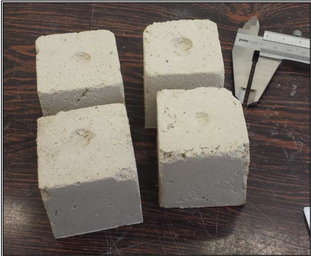
Figura 25 - Marca da esfera de aço do ensaio de dureza superficial sobre os corpos de prova. Fonte: Autoria própria.
