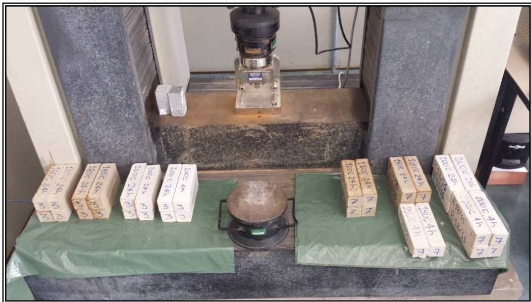
Figura 30 - Amostras de gesso calcinado de 3 e 7 dias para ensaio de tração a flexão. Fonte: Autoria própria.
