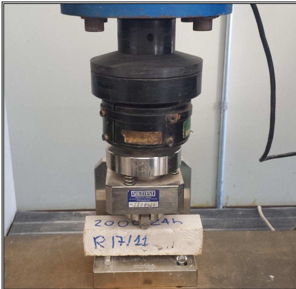
Figura 22 - Ensaio de tração na flexão realizado no corpo de prova prismático 200 °C - 24 h.
