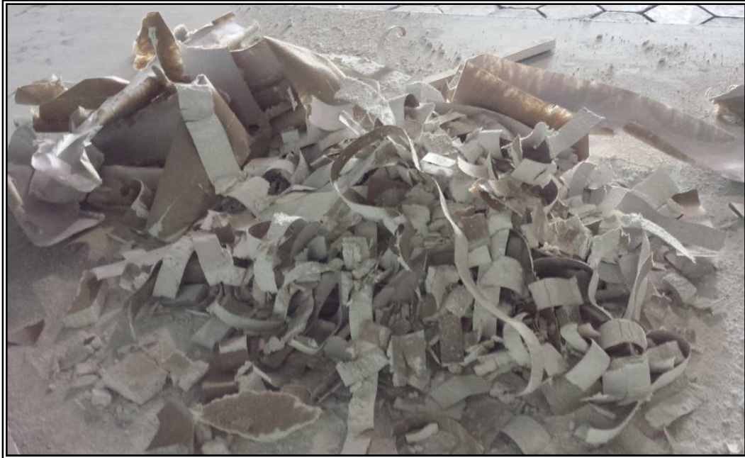
Figura 7 - Material resultante após a primeira passagem no cilindro manual. Fonte: Autoria própria.
