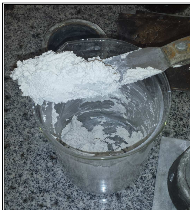
Figura 16 - Pasta homogênea de gesso calcinado a 200 °C por 4 h. Fonte: Autoria própria.
