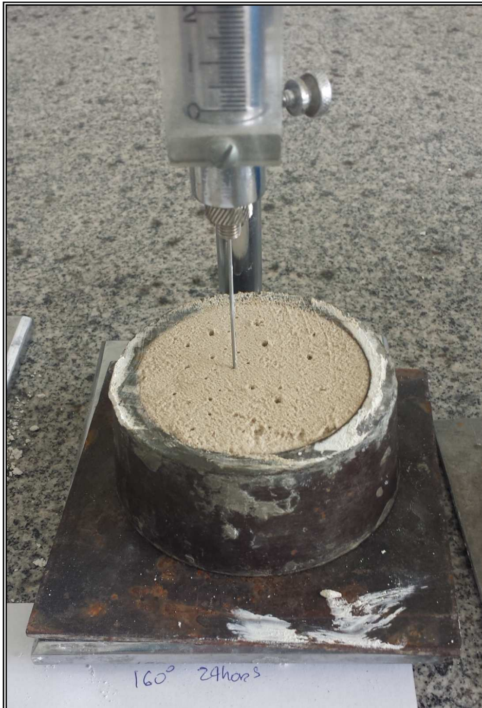
Figura 18 - Fim de pega do gesso calcinado a 160 °C por 24 h. Fonte: Autoria própria.
