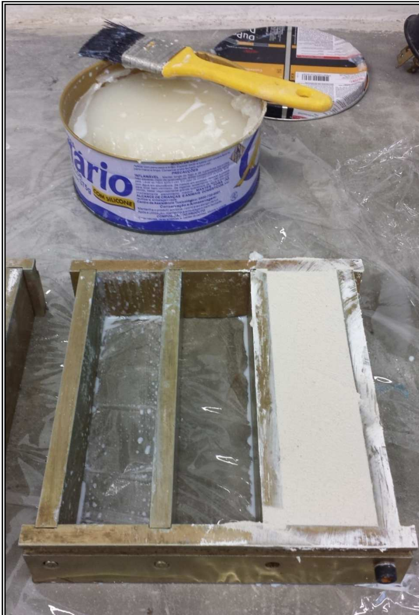
Figura 19 - Molde padronizado pela NBR dimensões 4 x 4 x 16 cm untado com cera. Fonte: Autoria própria.
