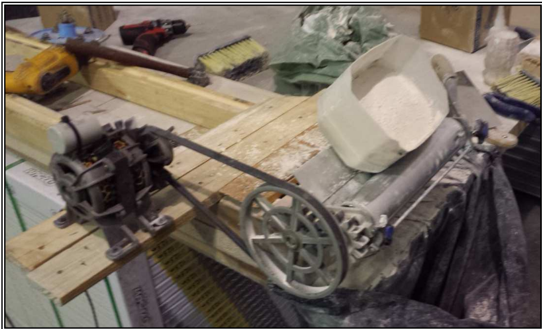
Figura 9 - Cilindro manual adaptado com motor. Fonte: Aatoria própria.
