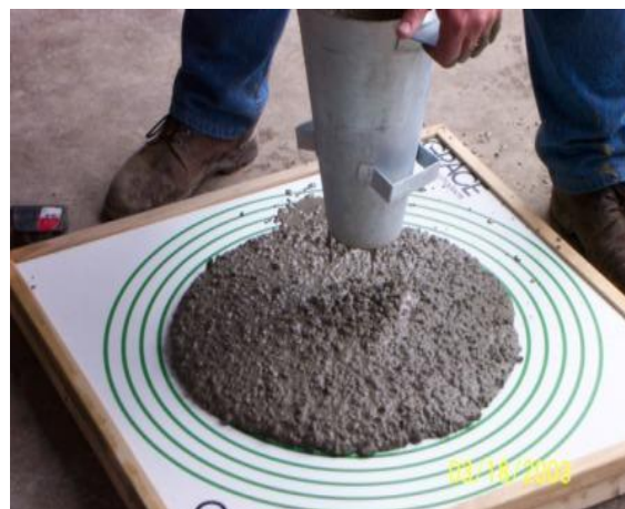
Figura 7 – Espalhamento do Concreto
