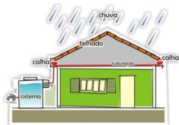
Figura 10 – Sistema de captação com cisterna. Fonte: Projeto água das chuvas (2016).
