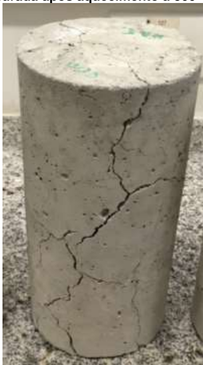
Figura 14 - Amostra fissurada após aquecimento a 800°C e resfriamento natural.
