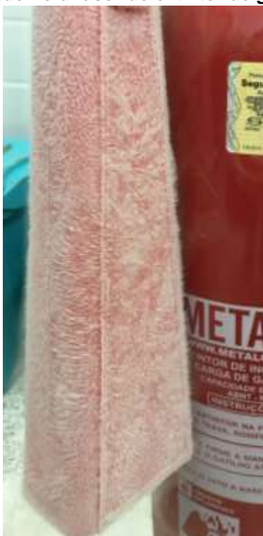
Figura 12 - Gelo formado no difusor do extintor de gás carbônico.
