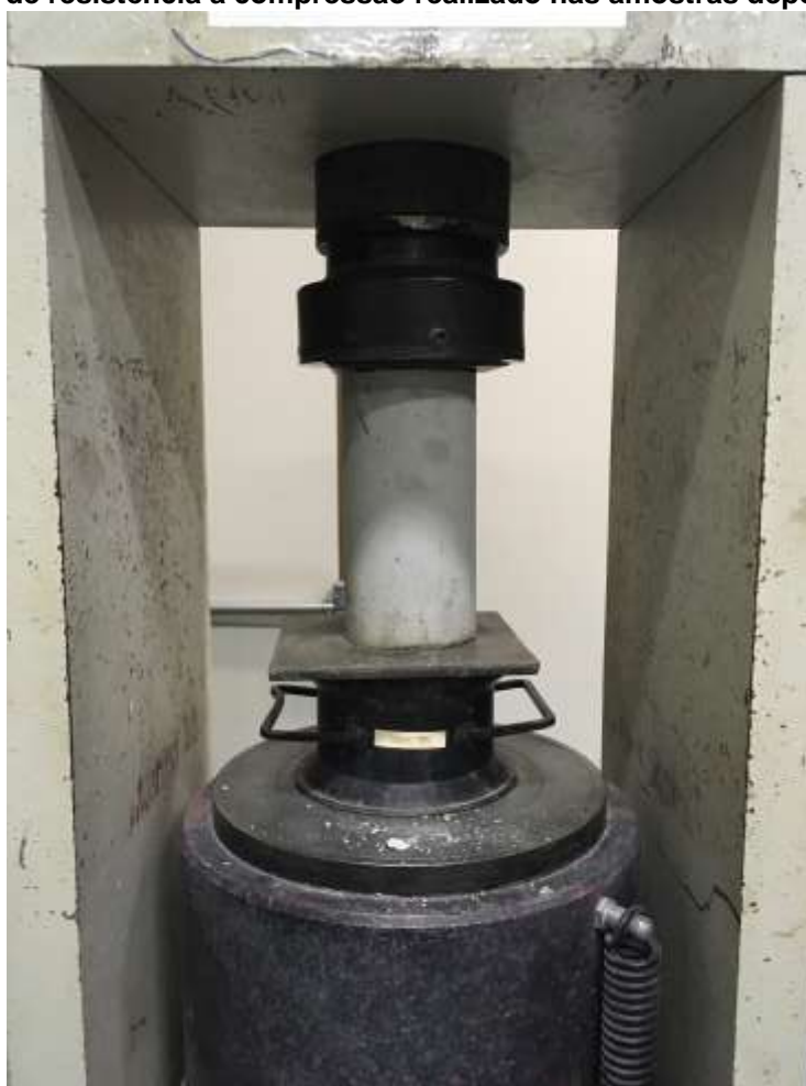
Figura 8 - Teste de resistência à compressão realizado nas amostras depois de resfriadas.
