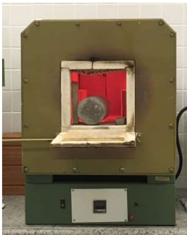
Figura 5 - Amostra inserida na mufla uma de cada vez para a temperatura de 800°C.
