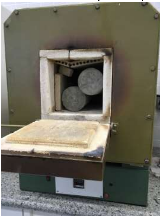
Figura 4 - Amostras inseridas duas de cada vez para as temperaturas de 400°C e 500°C.
