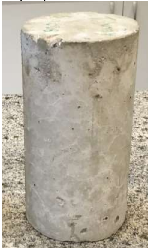
Figura 15 – Amostra após aquecimento a 800°C e resfriamento com água.
