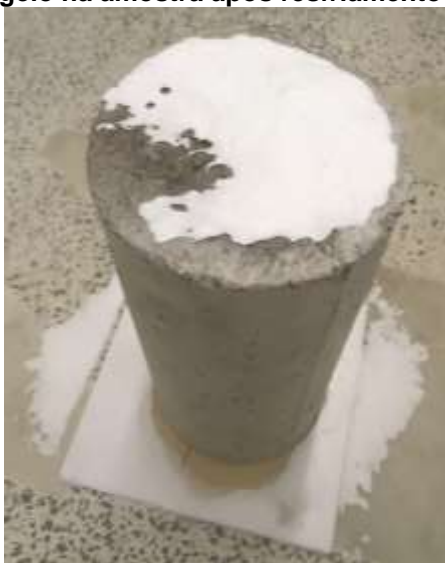
Figura 11 - Camada de gelo na amostra após resfriamento com uma carga de CO 2 .
