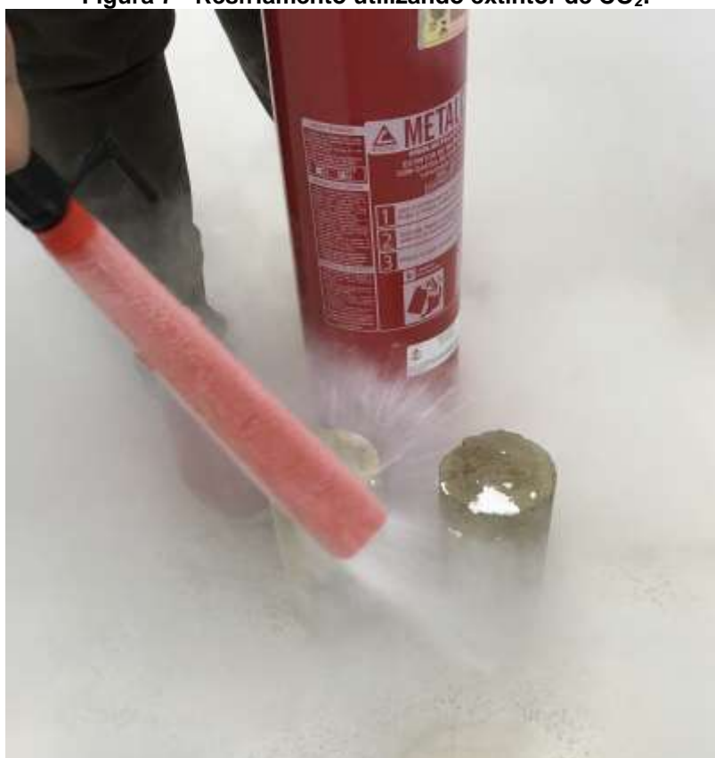
Figura 7 - Resfriamento utilizando extintor de CO 2 .
