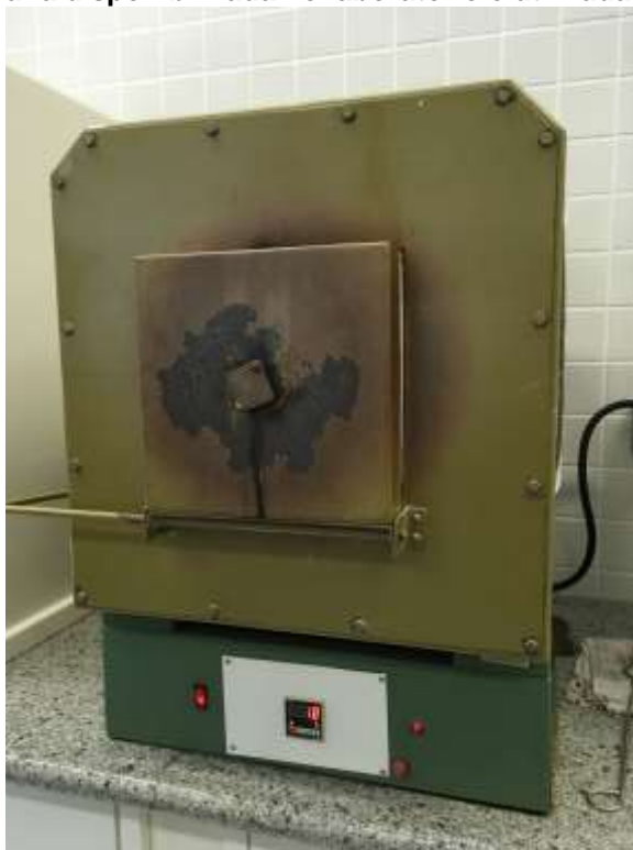
Figura 3 – Mufla disponibilizada no laboratório e utilizada nos ensaios.
