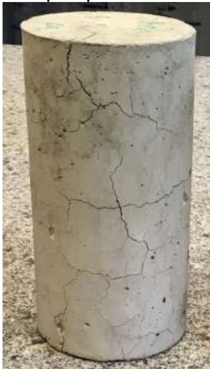
Figura 13 - Amostra fissurada após aquecimento a 800°C e resfriamento com CO 2 .
