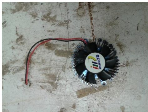
Figura 29: Cooler e dissipador Fonte: Acervo do autor (2014)
