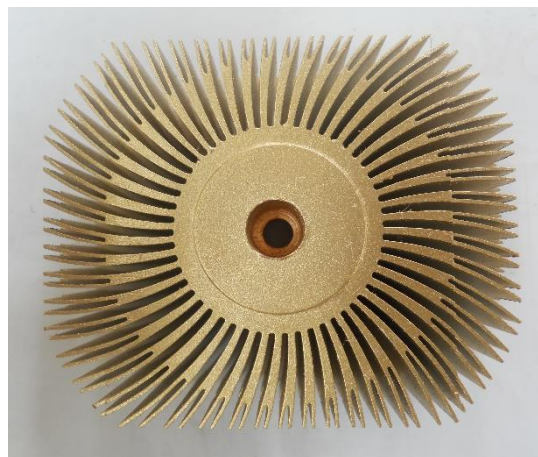
Figura 80: Dissipador com intervenções Fonte: Acervo do autor (2014)
