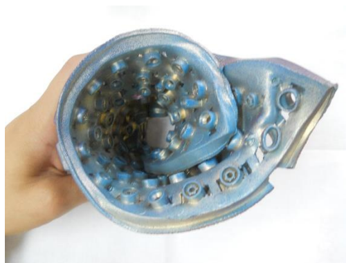
Figura 86: Cúpula – lado interno Fonte: Acervo do autor (2014)
