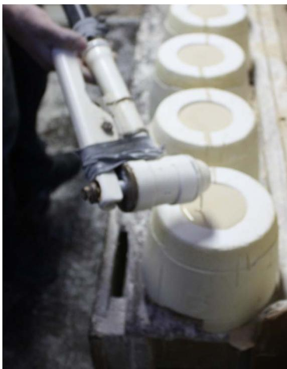
**Figura 17 –Processo de colagem de barbotina.
