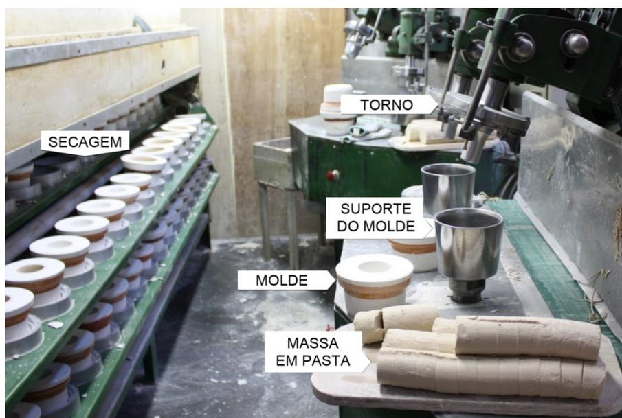
**Figura 18 –Processo de torno automatizado (*roller*).**
