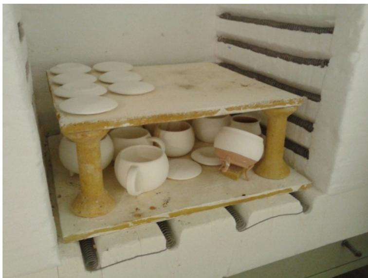
**Figura 35– Montagem do forno para a queima do esmalte.**
