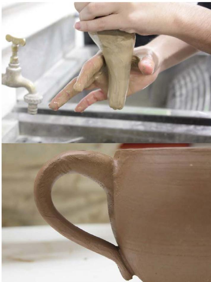
**Figura 29– Modelagem e colagem da alça.**
