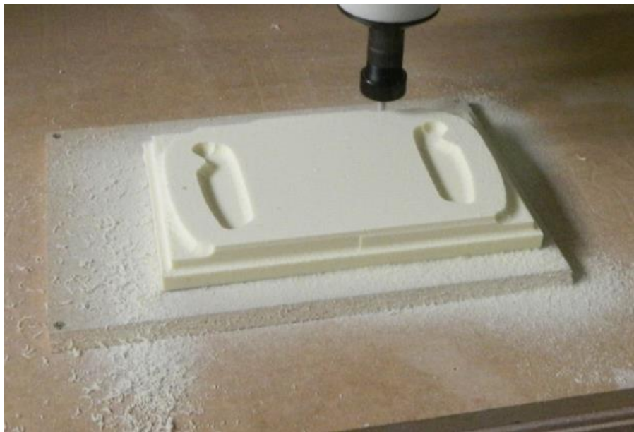
Figura 41: Usinagem do primeiro lado do mock-up Fonte: As autoras (2014).
