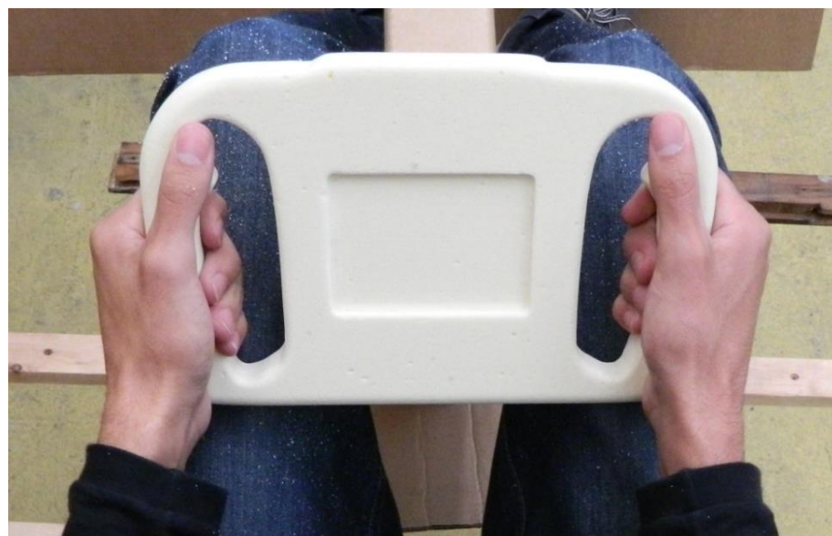
Figura 45: Teste de Mock-up com percentil 99 masculino Fonte: As autoras (2014).
