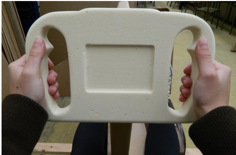
Figura 44: Teste de Mock-up com percentil 1 feminino Fonte: As autoras (2014).
