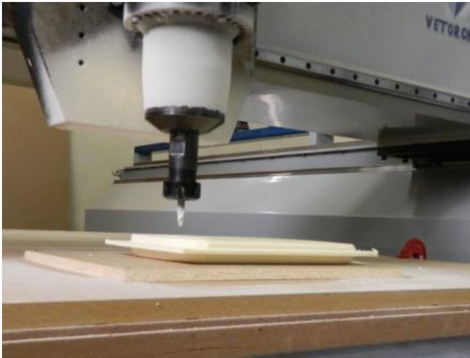
Figura 42: Usinagem do segundo lado do mock-up Fonte: As autoras (2014).
