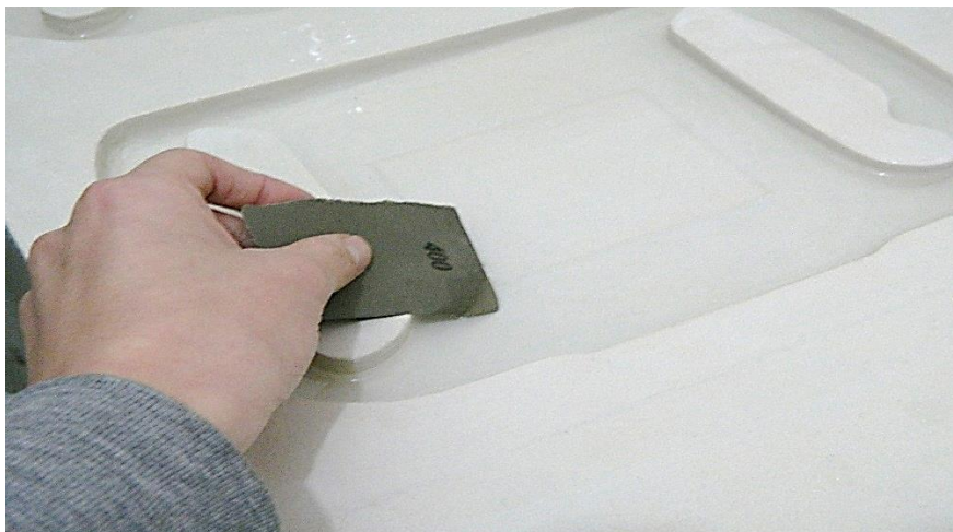
Figura 49: Molde sendo lixado com lixa d'água Fonte: As autoras (2014).
