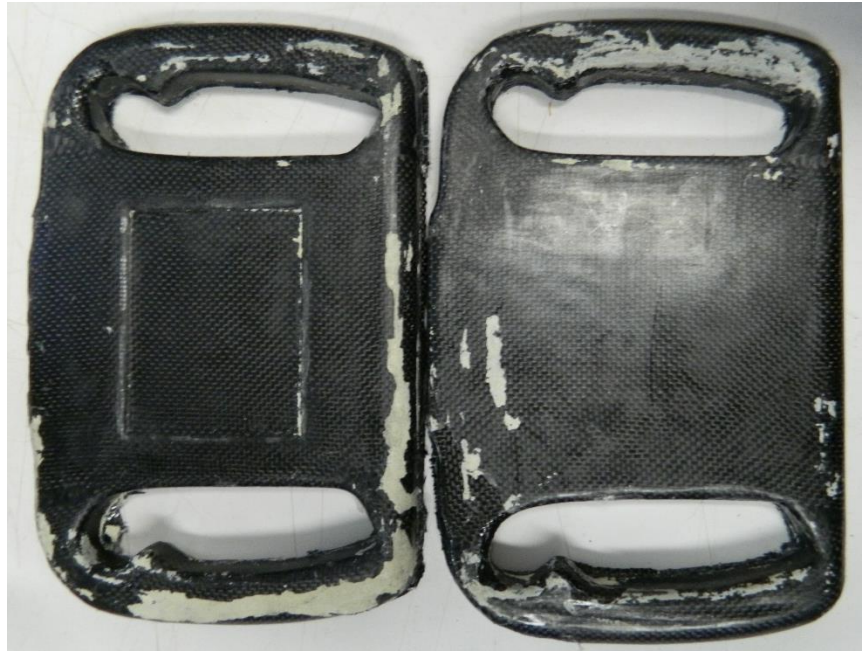
Figura 59: Desmoldante e massa plástica sobre a peça Fonte: As autoras (2014).
