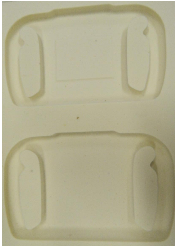
Figura 47: Molde usinado em PU Fonte: As autoras (2014).
