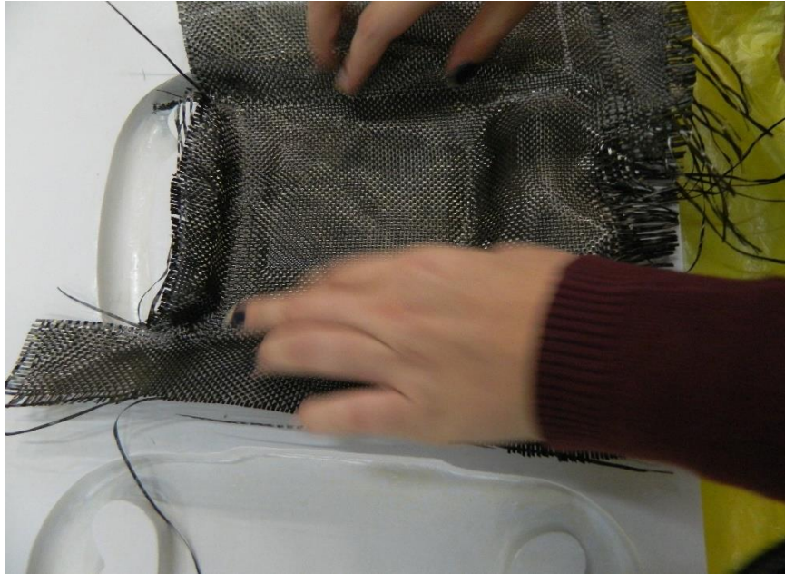
Figura 54: Ajustando cortes de tecido de fibra de carbono Fonte: As autoras (2014).
