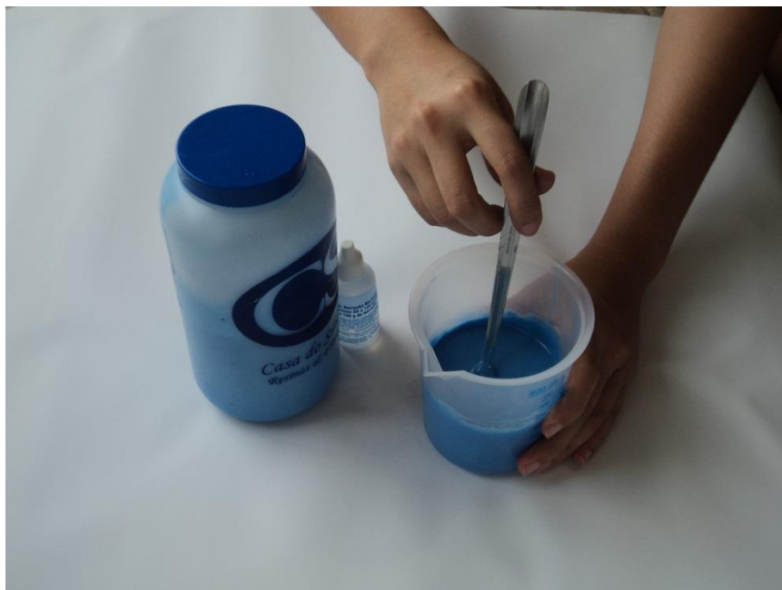
Figura 65: Mistura do silicone nacional para molde com catalisador. Fonte: Arquivo pessoal.
