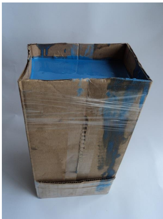
Figura 66: Molde de silicone. Fonte: Arquivo pessoal.
