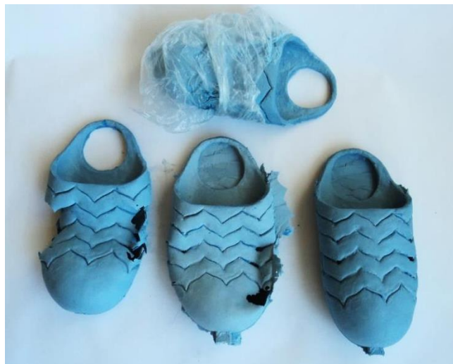
Figura 70: peças de silicone com defeito. Fonte: Arquivo pessoal.
