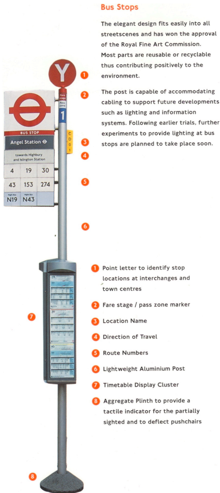
Figura 16 – Parada de ônibus da TfL sem abrigo, em detalhes.
