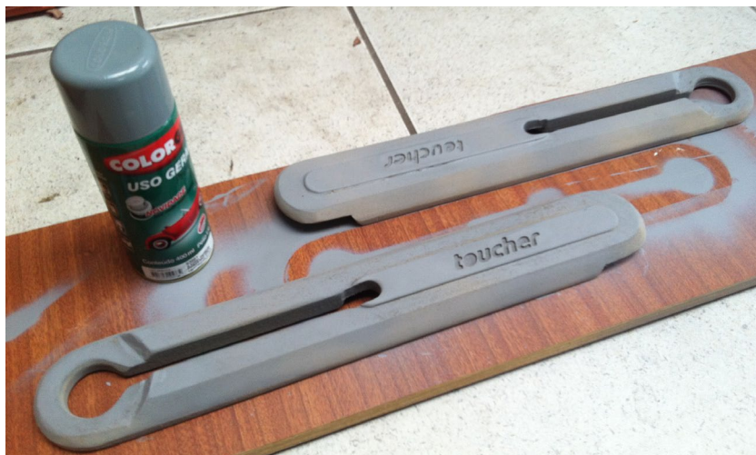
Figura 83 - Aplicação de fundo primer Fonte: Autores 2013
