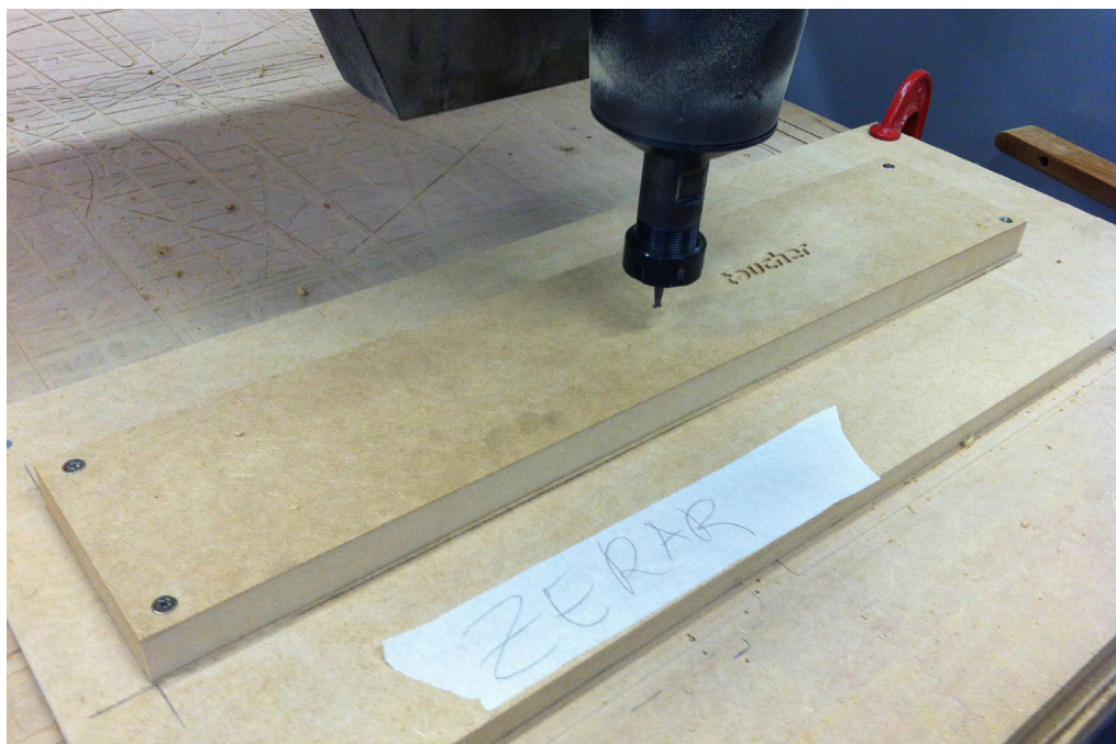
Figura 79 - Máquina CNC com bloco para usinagem Fonte: Autores 2013
