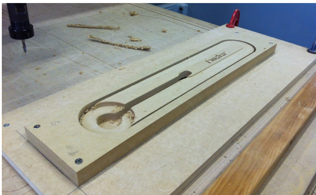
Figura 80 - Usinagem lado superior Fonte: Autores 2013
